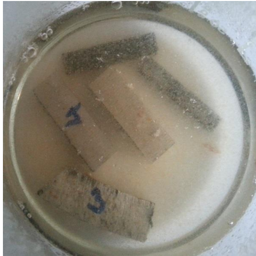
5. ábra Korróziós kísérlet mesterséges tengervízben 14
