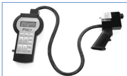
10. ábra Az ICx Technologies által kifejlesztett, AFP technológián alapuló, hordozható Fido kézi detektora. (Az ICx Technologies engedélyével.)
