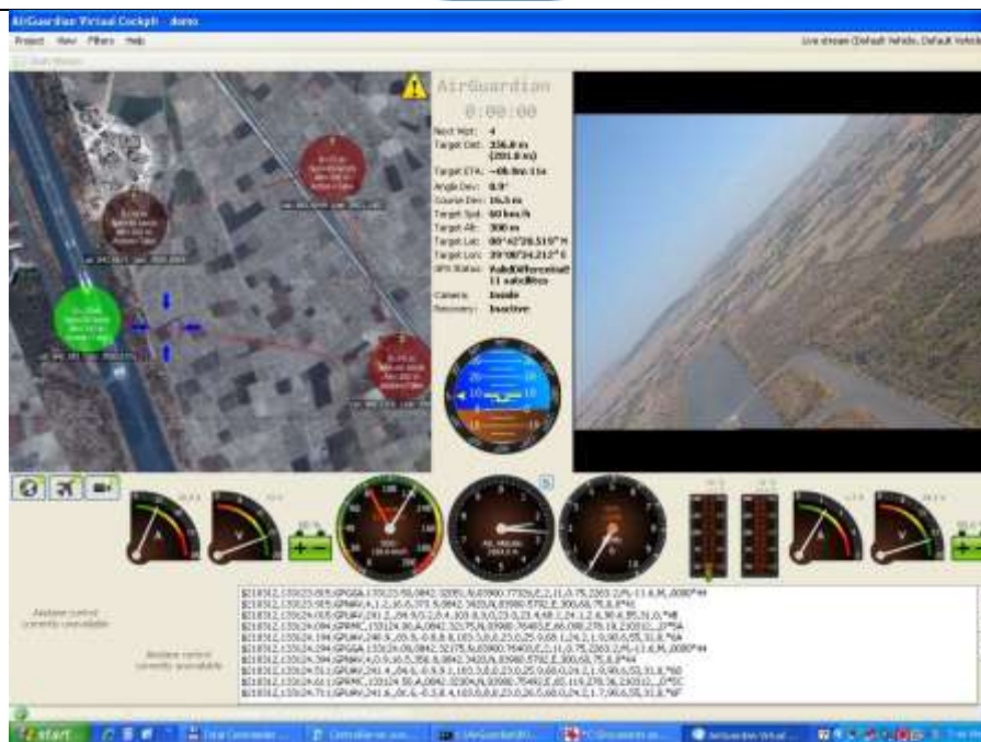
7. ábra A virtuális pilótafülke egy tipikus konfigurációja
