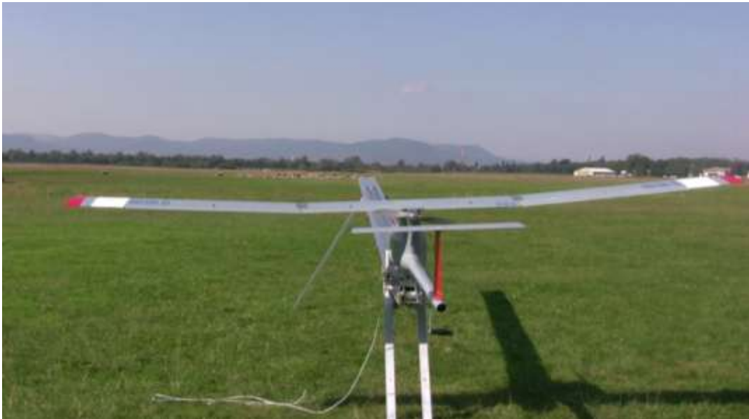
5. ábra A gép a kézi felhúzású gumiköteles katapulton
