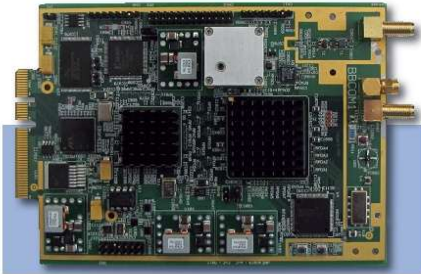
15. ábra A kommunikációs jelfeldolgozó kártya (BBCOM) fényképe
