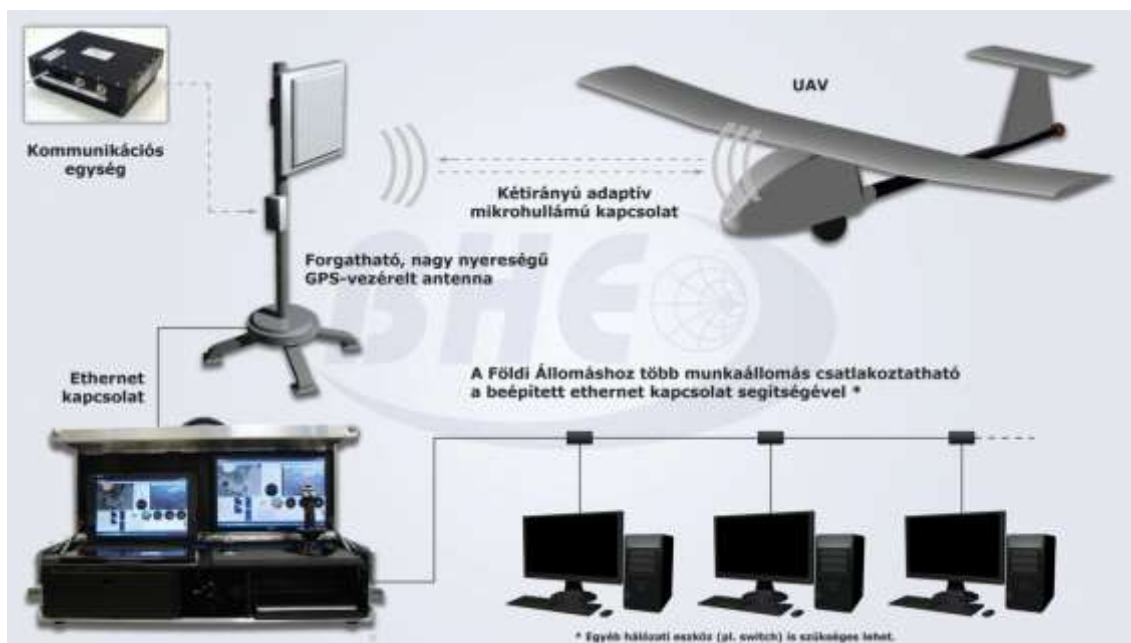
1. ábra Az UAV rendszer funkcionális felépítése
