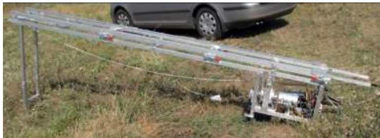
3. ábra Az elektromotoros katapult fényképe
