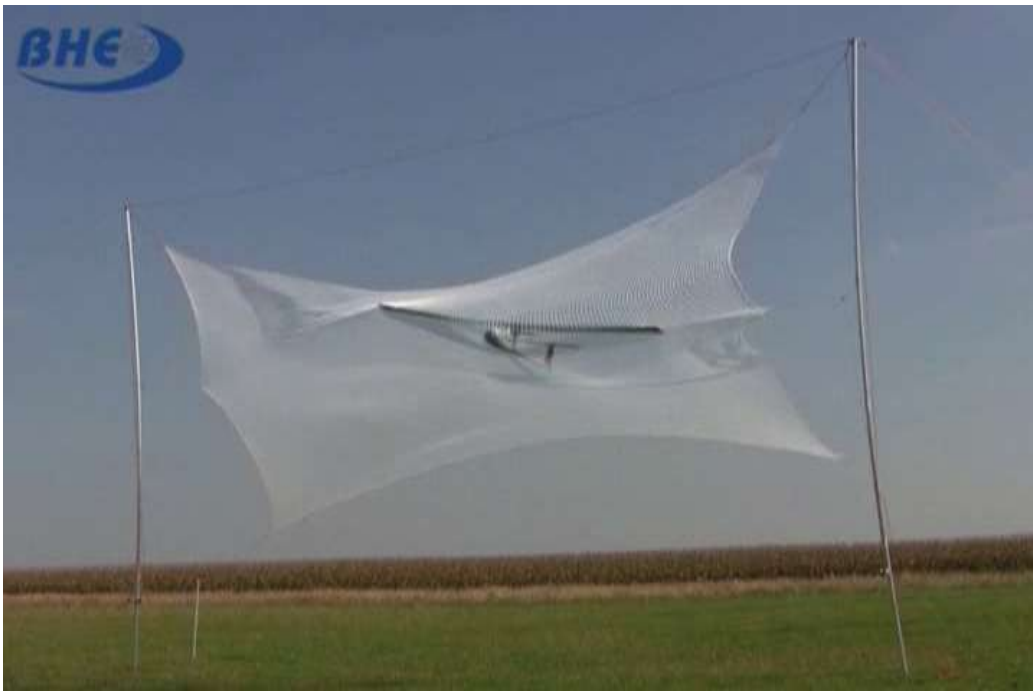
16. ábra Az UAV a leszállító hálóban
