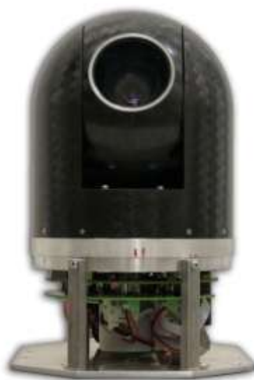
13. ábra Stabilizált kameraplatform fényképe
