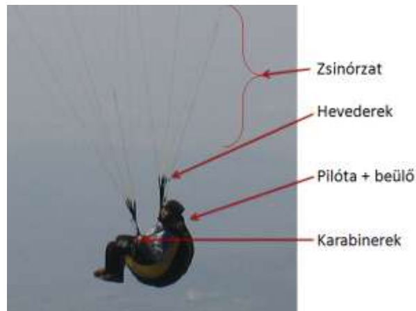
7. ábra Siklóernyő felépítése
