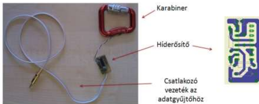
11. ábra A megvalósított erőmérő egység és NYÁK terve
