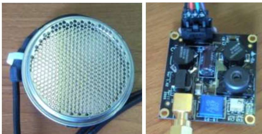
4. kép Az akusztikus magasságmérő antennája és adó/vevő berendezése 8
