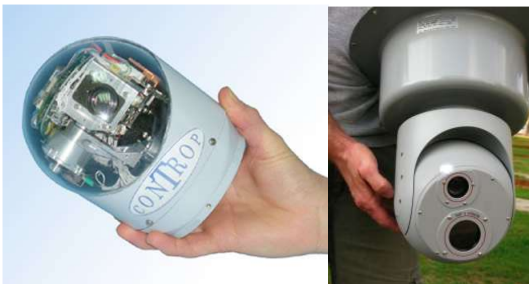
3. kép Robotrepülőgépbe beépíthető dome kamerák 10
