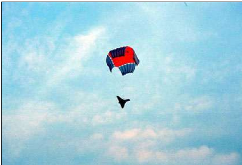
3. kép A képen egy SPERWER látható ejtőernyős leszállítás közben 6
