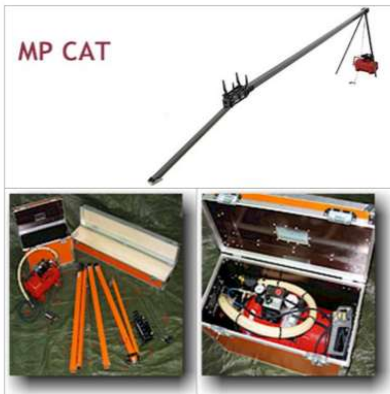
4. kép. A MicroPilot MPCAT légsűrítővel működő katapultja 7
