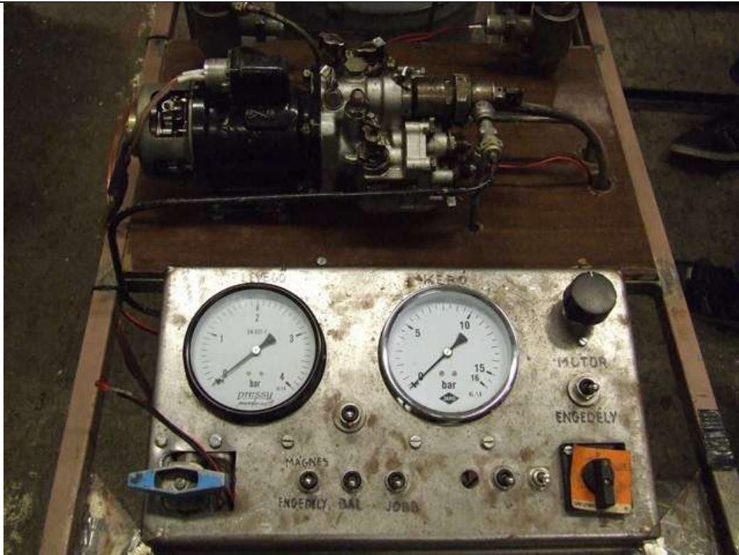
17. ábra A 924-es próbapad kezelőpultja és a vizsgált szivattyú
