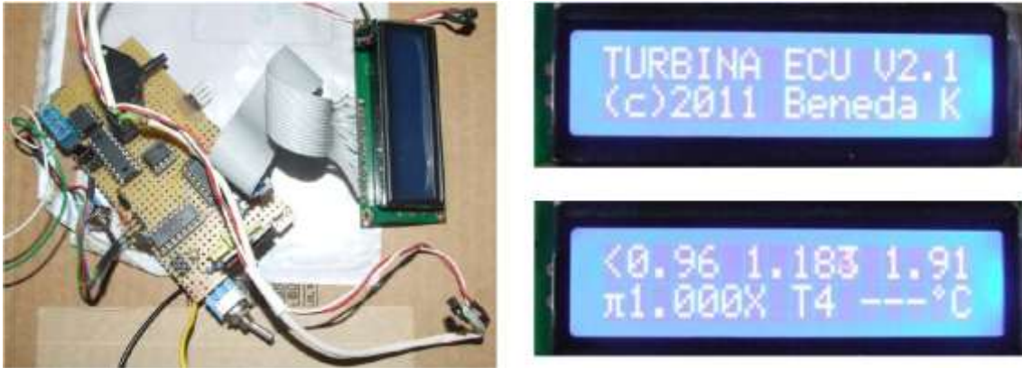
4. ábra A rádió távirányítású változat és képernyőjén megjelenő információk
