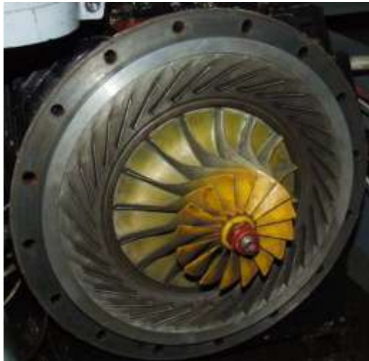
1. ábra A Ganz kompresszor járókereke és radiális diffúzora eltávolított csigaházzal
