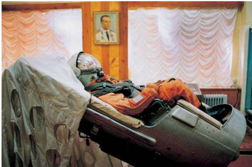
2. ábra. A Vosztok űrhajó katapultülése a Csillagváros egyik kiállítótermében. Jól megfigyelhető az ülés – a légáteresztőképesség növelése érdekében - speciális résekkel ellátott ejtőernyőkupolája a fejtámlára terítve.
