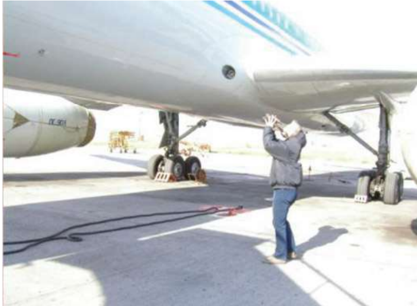
1. ábra A hagyományos hibafelmérés termokamerával 3
