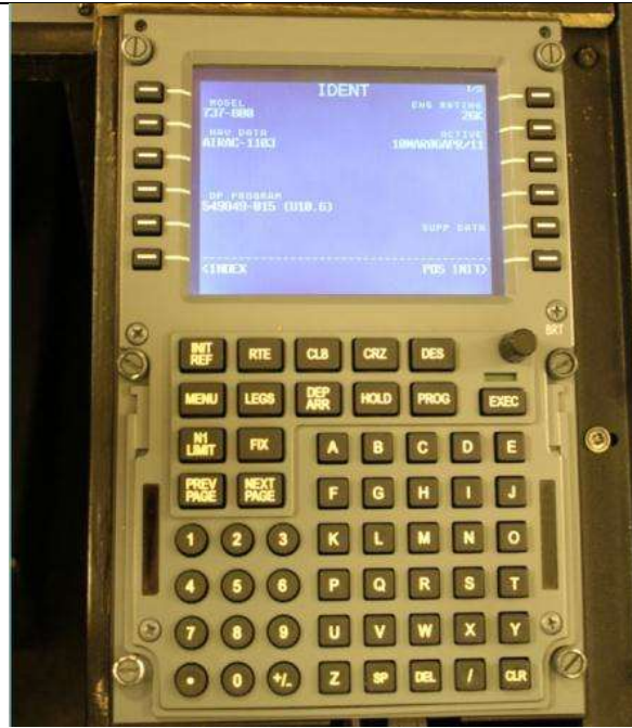
8. ábra A FlyEngravity CDU
