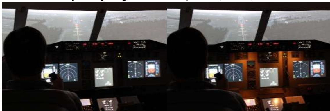
13. ábra balra: műszerfal világítás nélkül, jobbra: műszerfal bekapcsolt világítással
