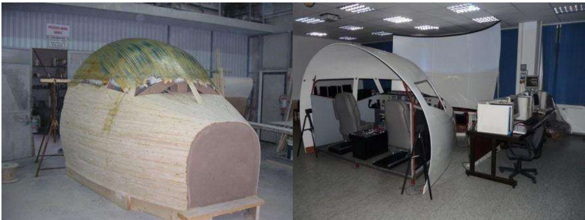
2. ábra balra: a szimulátor burkolata építés közben, jobbra: a kész burkolat az új helyen
