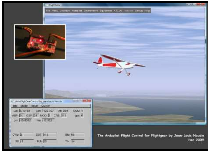
2. ábra FlightGear használata HIL szimulációra 3
