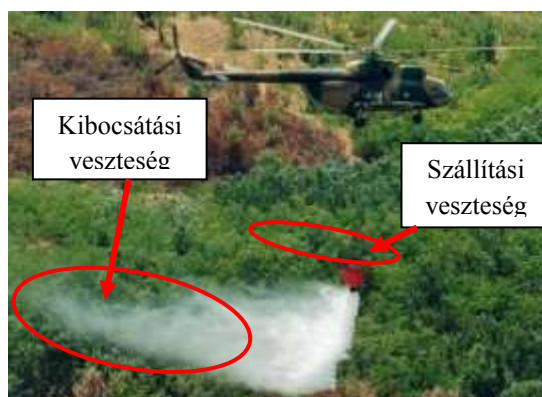
1. ábra A légi tűzoltás szállítási és kibocsátási veszteségei. Szerkesztés: szerző
