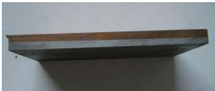
16. ábra Repülőgép hőcserélőjénél alkalmazott acél-réz anyag és a magyar acél-réz anyagminta
