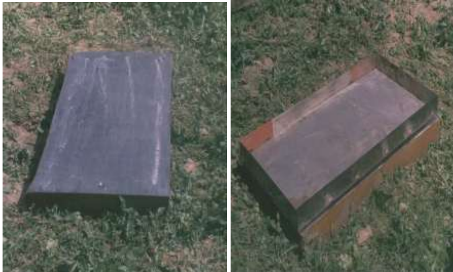
10. ábra Robbantásos plattírozáshoz előkészített anyagok
