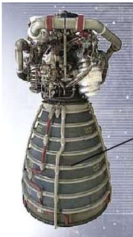
9. ábra Rakétahajtómű robbantással kialakított harangja 20
