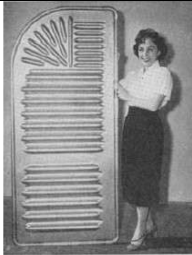
11. ábra Alumínium ötvözet, hullám-alakzatra robbantott repülőgép panel 22
