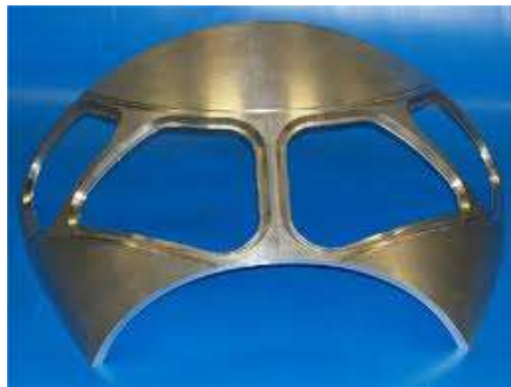
12. ábra Airbus robbantással formált pilótafülke-része [44]
