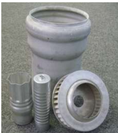
36. ábra Elektrodinamikus alakítással készített alkatrészek
