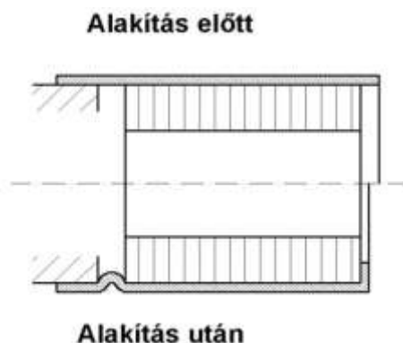
20. ábra Villamosmotor állórész lemezeinek összefogása
