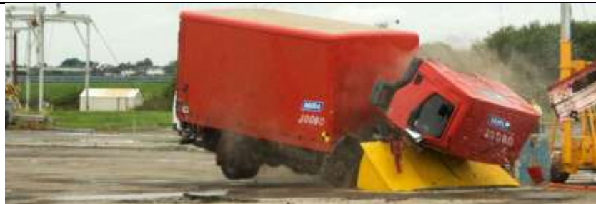
4. ábra. Hidraulikusan emelt útzár tesztelése 8
