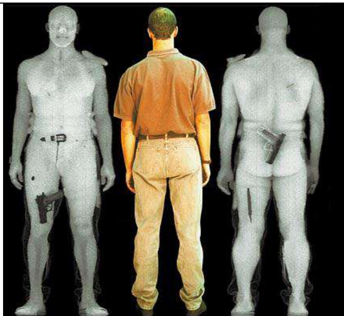
8. ábra Személyi átvilágító berendezés képe 13
