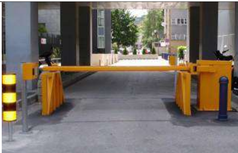
6. ábra Emelkedő típusú sorompó 10
