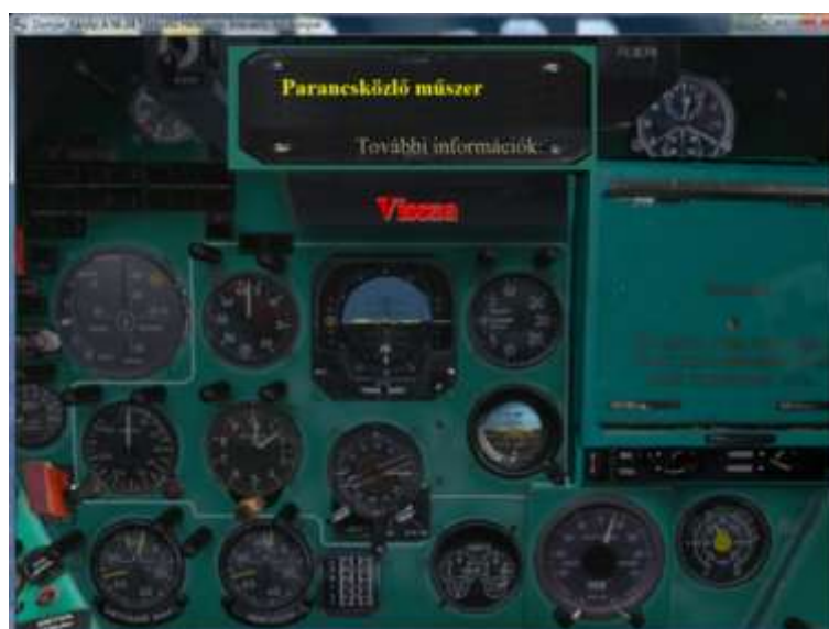
17. ábra A helikoptervezető fülke műszerfal, a PKP-42 műszer információs paneljével
