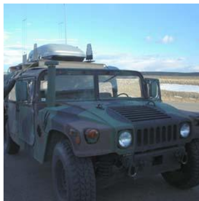
5. – 6. kép. Bombazavaró gépjárművek polgári és katonai kivitelben [4]
