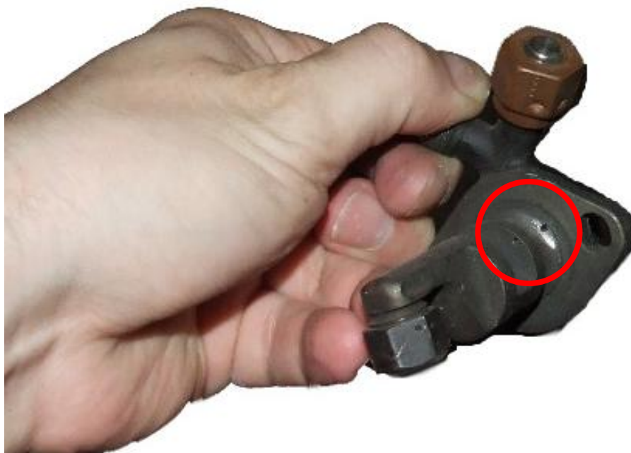
11. ábra. A furattal ellátott tüzelőanyag-fűvóka
