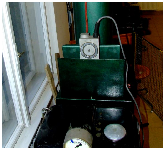
15. ábra. Az erőmérő cella beépítés előtt
