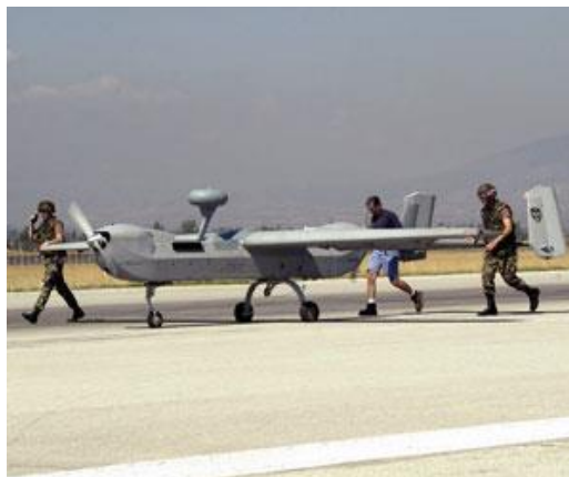
2. kép TACTICAL kategóriájú az IAI RQ-5 Hunter típusú UAV 9
