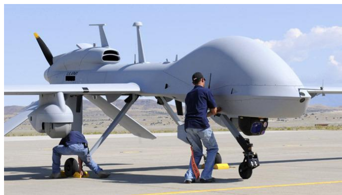
4. kép Az US Army MQ-1C Gray Eagle UAV-ja két kiegészítő szárny alatti EO/IR szenzorral 29
