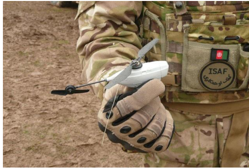
1. kép Nano kategóriájú PD-100 Black Hornet PRS UAV 8
