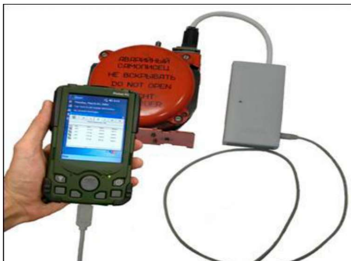
23. ábra MVD-23 kiolvasási összeállítás [43]
