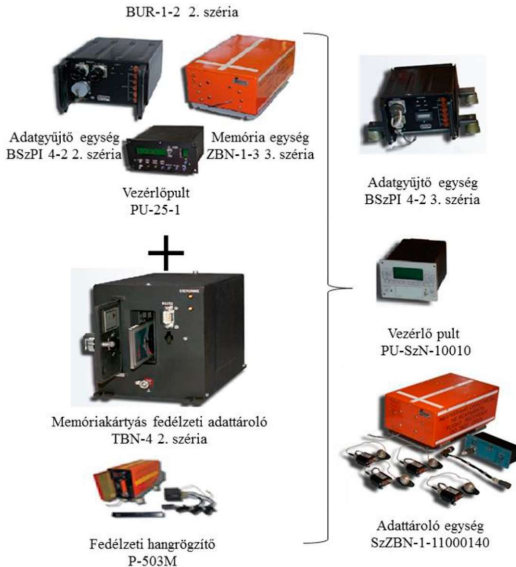
20. ábra A BUR-1-2 3. szériás repülési adatrögzítő 12 [21]
