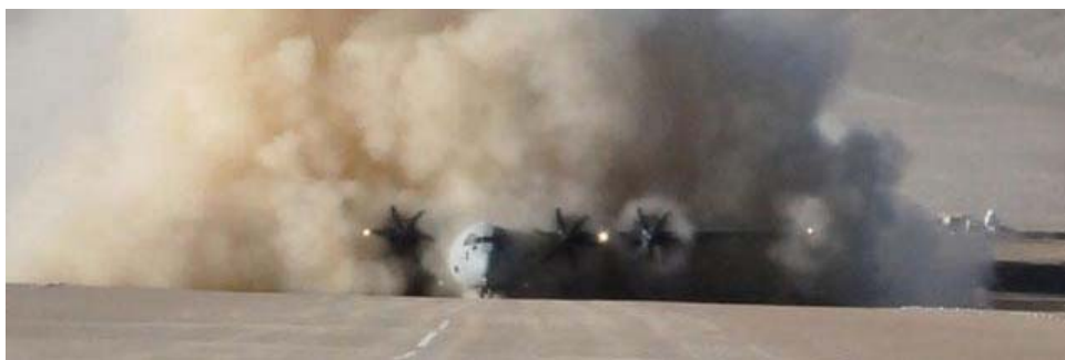
7. ábra Egy C-130J Super Hercules légsavarak reverzálásával végrehajtott fékezése egy szükségrepülőtérén 39
