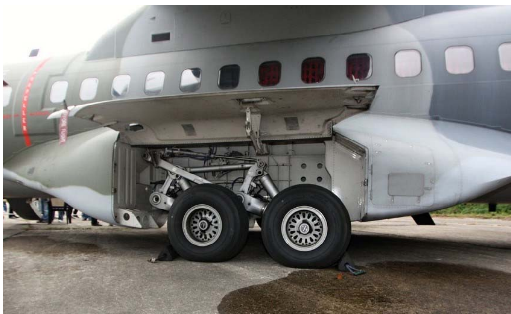
85. ábra A főfutó felépítése 133 (Saját szerkesztés)
