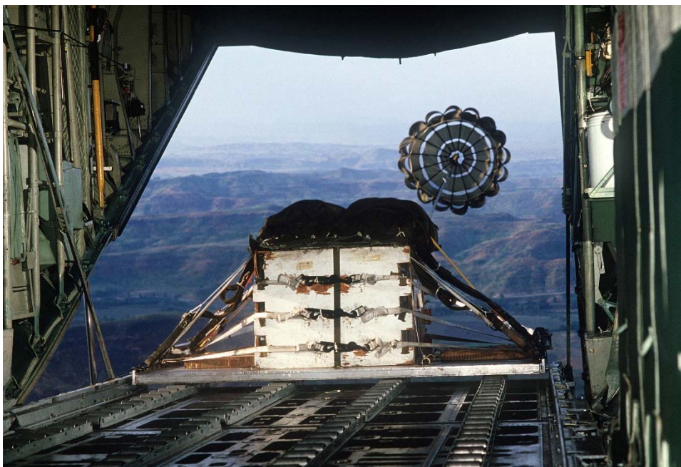
244. ábra Teher nagy magasságban végrehajtott deszantolása C-130 repülőgépből végrehajtva 57
