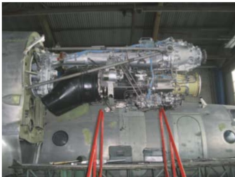
71. ábra A TV3-117VMA-SzBM1 típusú hajtómű felépítve az An-26 repülőgép jobb oldalára [23] (Saját szerkesztés)
