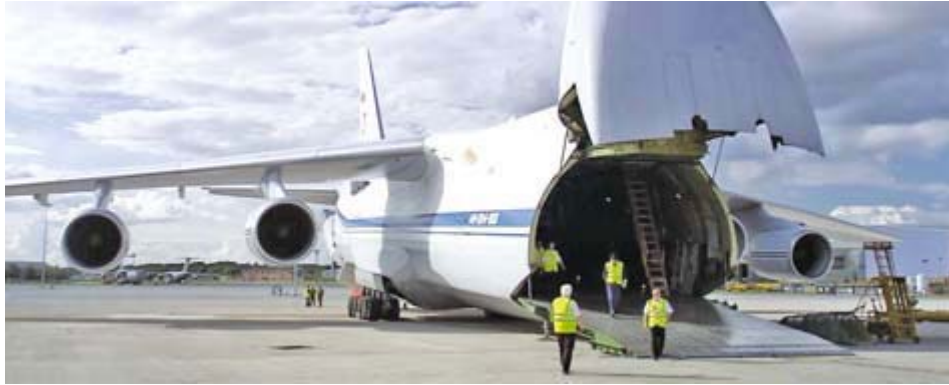
12. ábra An-124 orr rész felnyitva, orrfutó bekötési csomópont körül elforgatva, összecukható rámpa leengedve. Rakodásra kész. 46
