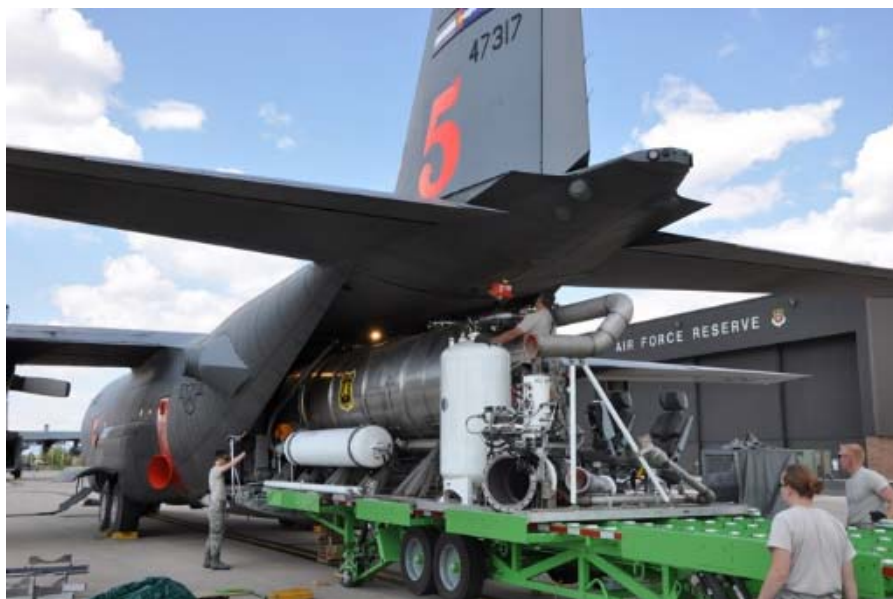
52. ábra C-130 átalakítását követő platform beépítése 90
