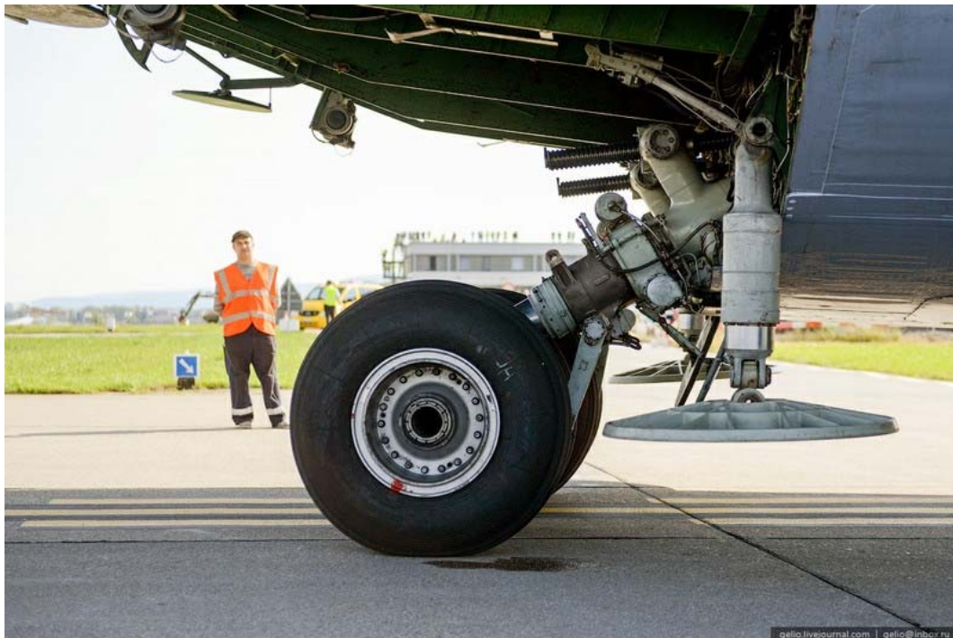
13. ábra An-225 orrfutó elfordítása bekötési csomópont körül, valamint jól látszanak a törztámaszok 47
