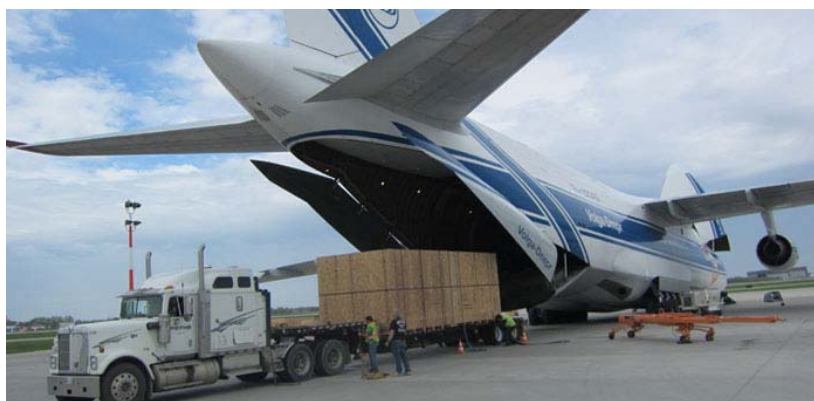
11. ábra An-124 rakodása, mindkét rámpa nyitva 45
