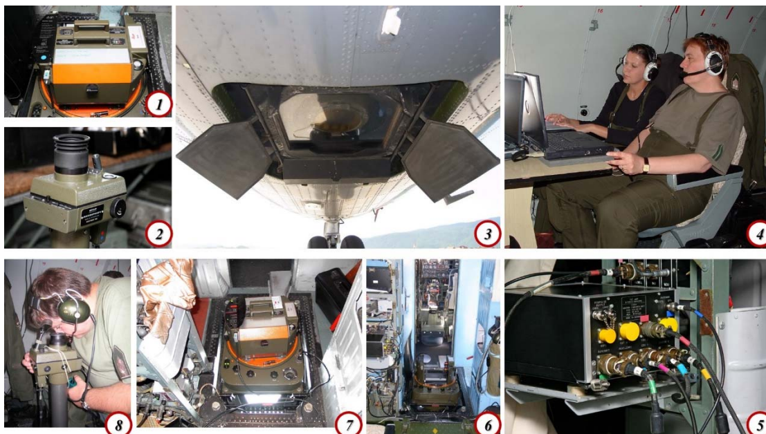
39. ábra Az An-26 repülőgép Open Skies feladatra történő átalakítása. 73 (Saját szerkesztés) (1) A kamera, (2) A navigációs távcső, (3) A fedélzetről működtethető kamera-nyílás ajtó, (4) Az operátorok munkahelye, (5) CCNS-4 kamera vezérlő rendszer integrálása, (6) Kamera fotókeret beépítése, (7) Kamera a helyén, a szükséges kábelek csatlakoztatva, (8) Az útvonalfigyelő munkahelye.
