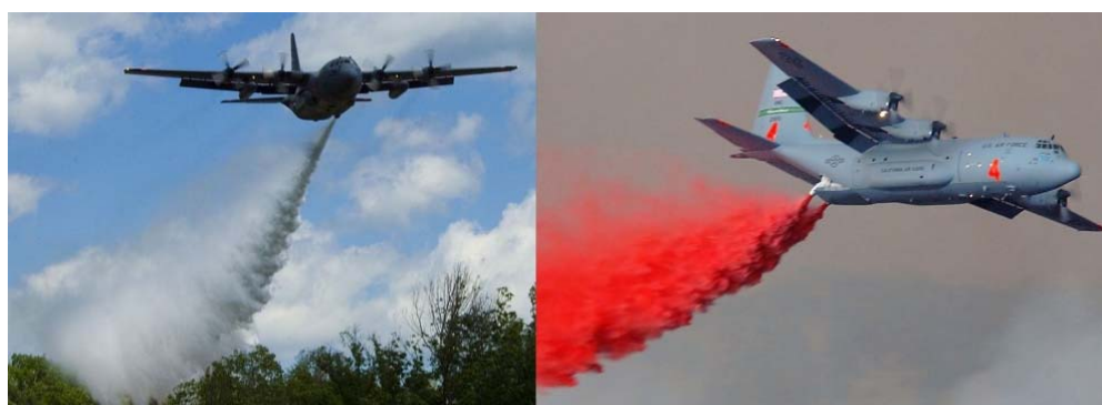
53. ábra C-130 repülőgépre beépített MAFFS változatok 91
