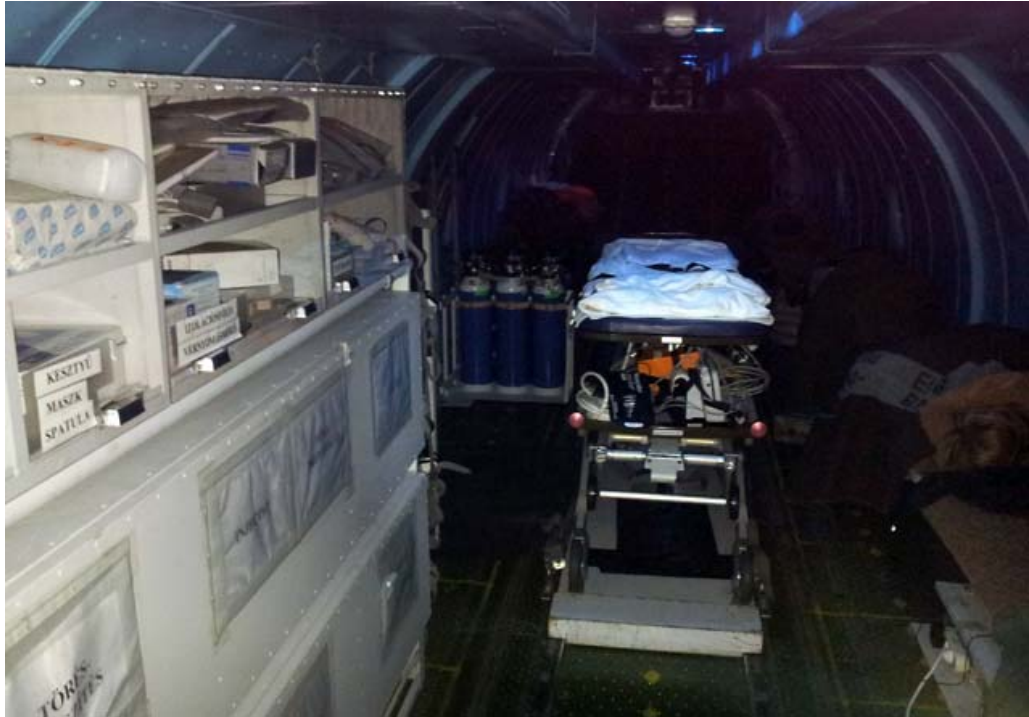
33. ábra An-26 tehertér Airevac feladatra berendezve [8]
