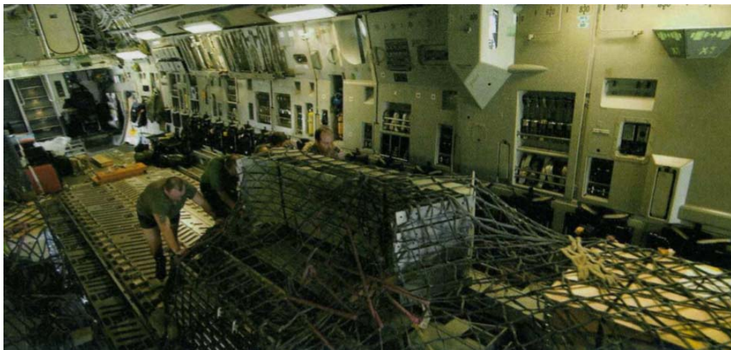
17. ábra A teher mozgatása görgősoron keresztül kézi erő alkalmazásával [22] (Saját szerkesztés)
