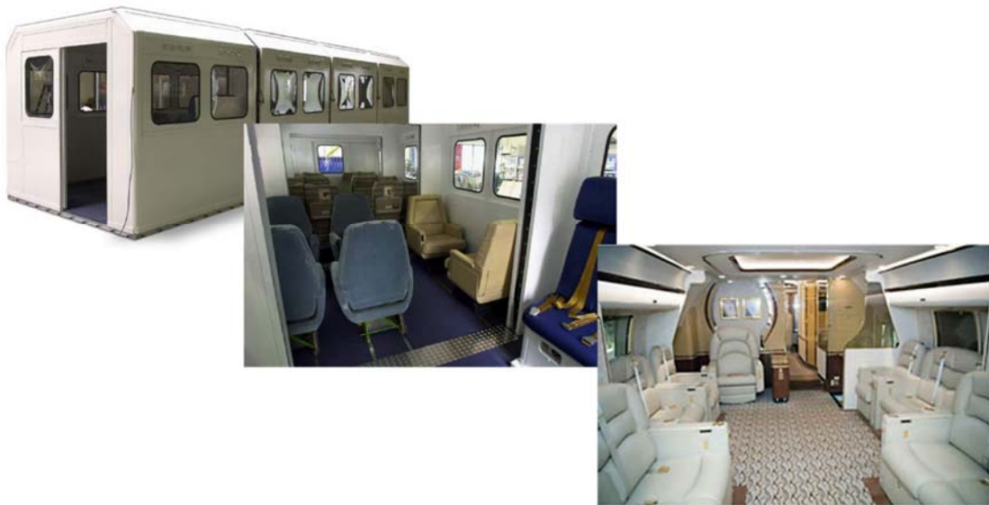
36. ábra A C-130 repülőgéphez kifejlesztett VIP konténer és egy állandó VIP kialakítás 70 (Saját szerkesztés)
