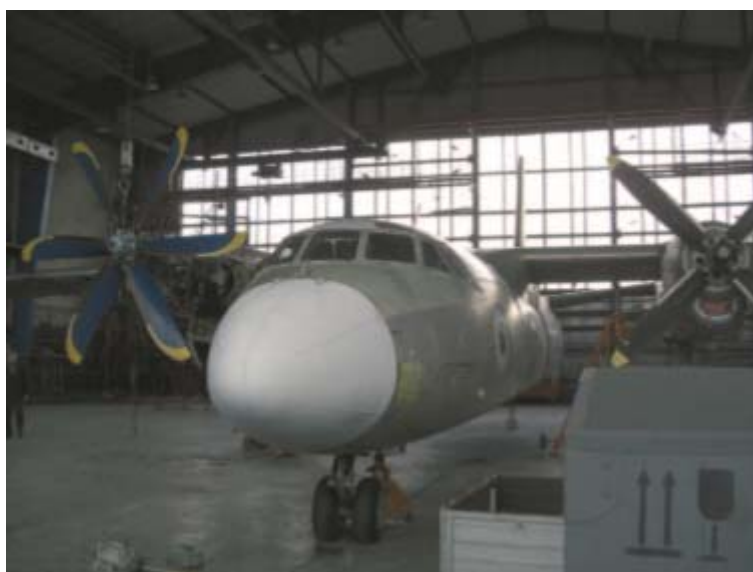
72. ábra An-26 repülőgép jobb oldalán az új típusú hajtómű és légszűrő, bal oldalán pedig az AI-24 VT hajtómű és AV-72T légszűrő [23] (Saját szerkesztés)
