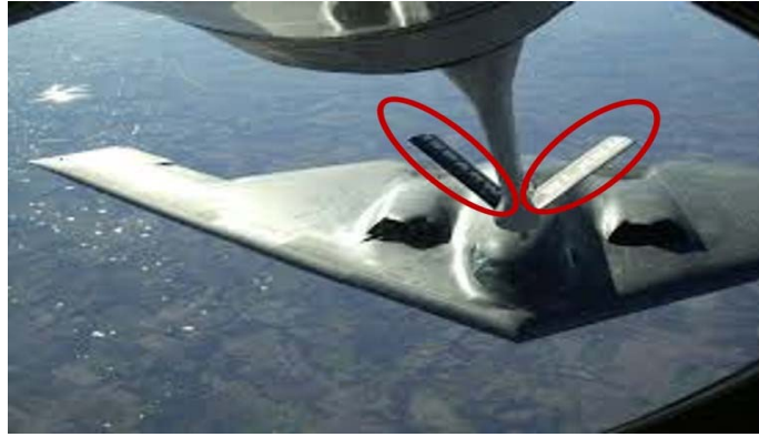
44. ábra A merev csöves (Boom) rendszer. Pirossal a kormánylapok jelölve. 81 (Saját szerkesztés)
