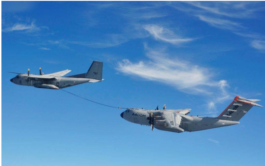
43. ábra A francia légierő C-160 Transall típusú repülőgépe végzi a légi utántöltést az Airbus A400M repülőgépen 80
