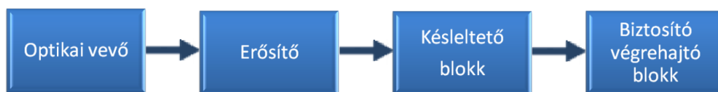
30. ábra Optikai közelségi gyújtó blokkvázlata [2][Nagy Norbert – MS Paint]
