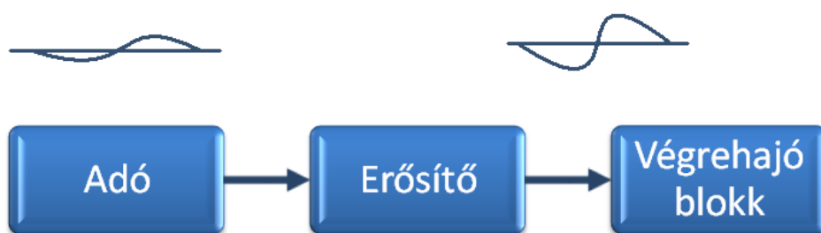
12. ábra Indukciós közelségi gyújtó blokk-sémája [2] [Nagy Norbert – MS Paint]
