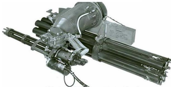
12. ábra M-21-es fegyverrendszer, M-134-es "MiniGun"-nal és M-158-as rakétaindító blokkal [71]
