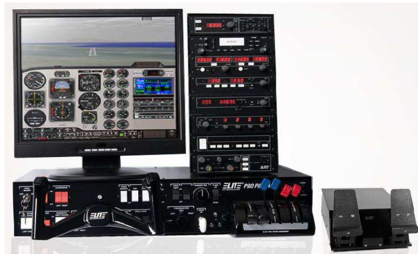
5. ábra Cessna-172 repülőgép kialakítását szimuláló ATD
