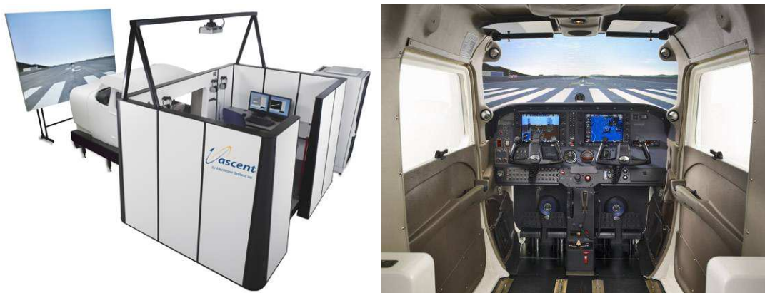
7. ábra: A Cessna repülőgépcsaládra kifejlesztett FNPT berendezés
