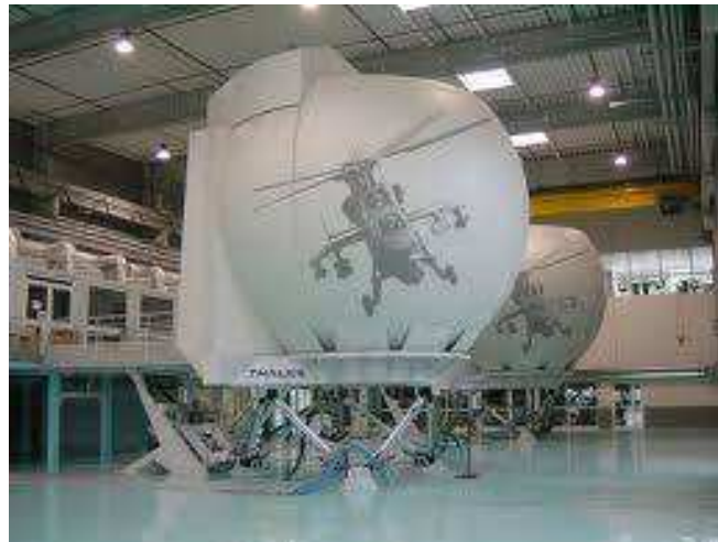
10. ábra Az EC 665 (NATO kódnév: Tiger) harci helikopterek harcászati alkalmazásának gyakorlására kialakított FMS berendezés
